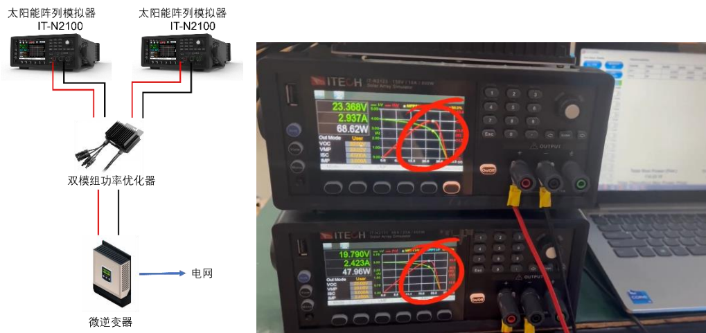
图四、不同配置的 IT-N2100 接功率优化器串联接微逆变器
