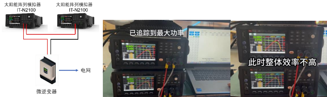
图三、串联两台 IT-N2121 在相同配置和不同配置下微逆变器的追踪情况
