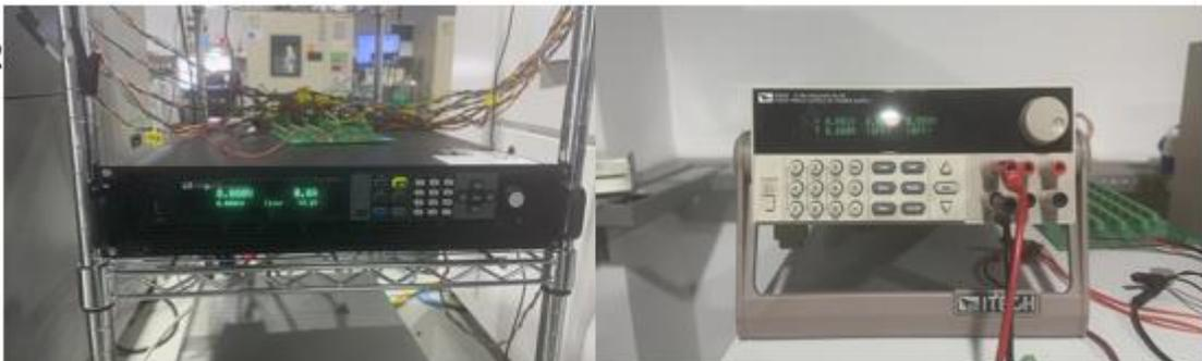
**IT-M3910D-10-1020、IT6302在电流传感器老化测试中的应用**
