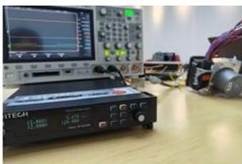
IT-M3100在车身稳定系统ESP电机的测试应用
